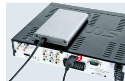
Bei den übrigen Modellen (hier: Smart) ist die USB-Buchse 2 an der Rückseite untergebracht.
