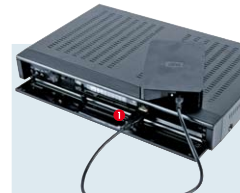
USB-Festplatten finden bei LogiSat und Triax-Hirschmann Anschluss an der Frontseite 1.
