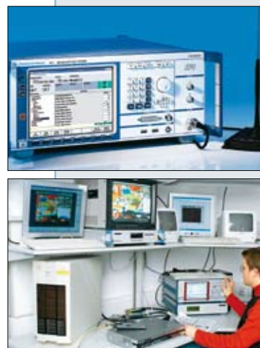
Oben: der Signalgenerator Rohde & Schwarz SFU. Unten: Ein Tester prüft die Detailgenauigkeit mit dem Analysesystem PQA 200.
